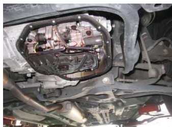
汚れたストレーナー
