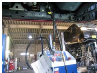
オイルクーラーホースより圧送
